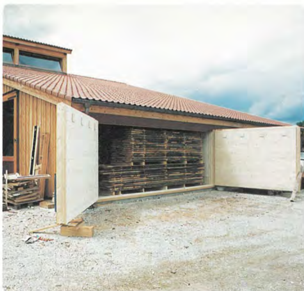
(36) Extradry. Die eigene Trockenkammer ist Voraussetzung für die Verarbeitung der regionalen Holzernte und ein Garant für die Qualitätssicherung am Anfang der Produktionskette.
